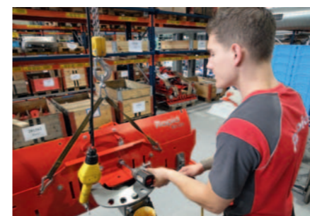
Simon Hagen, employé chez Rapid, lors du montage de la lame à neige.
