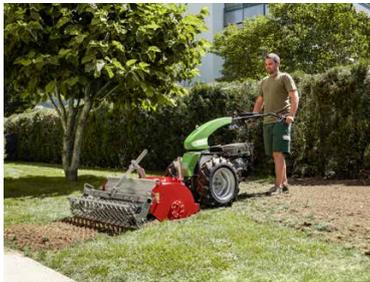
Dank stufenlosem Fahrtrieb, werkzeuglos wechselbaren Anbaugeräten und seitlich schwenk- wie drehbarem Holm ist der Rapid KIPOS der perfekte multifunktionell einsetzbare Einachsgeräteträger für den Garten- und Landschaftsbau. Die kompromisslos für Bodenfräsarbeiten ausgelegte Balance ermöglicht selbst über lange Arbeitstage ein kräfteschonendes und einfaches Arbeiten.
