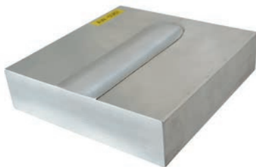
Grosse Einsweisstiefen in einer Schweißung: Kupfer bis 20 mm, Aluminium bis 30 mm
