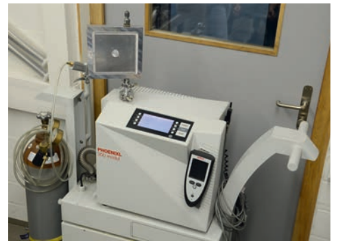
Durchführung von Dichtigkeitsprüfungen im eigenen Labor in Wasser und im Vakuum bis 10^{-12} bar
