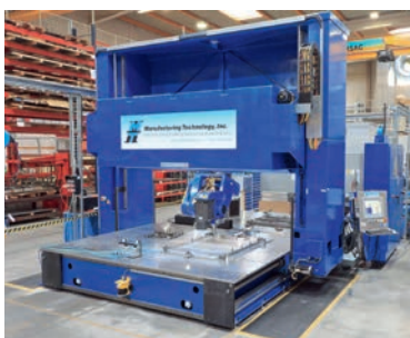
6-Achsen-Schweissanlage GG-1 für Werkstückdimensionen bis 4500 x 2500 x 1250 mm
