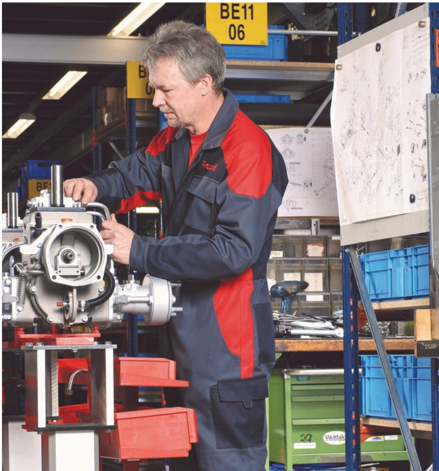
Montage einer Gehäusebaugruppe
