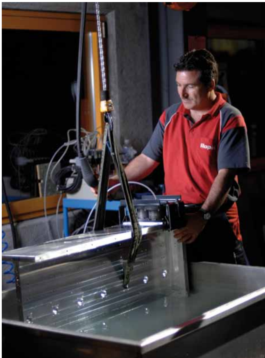
Konsequente Qualitätskontrolle inkl. FSW-Dichtigkeitsprüfung
